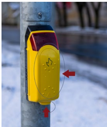
Katrā no luksoforiem ir iebūvētas divas izsaukuma pogas gājējiem: viena atrodas uz dzeltenā bloka vertikālās virsmas un otra – zem dzeltenā bloka.
